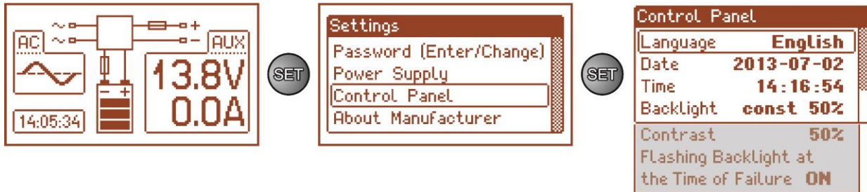
Fig. 23. „Control panel” screen.
