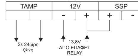
Σύνδεση με τέσσερις αγωγούς. Τάση φόρτισης μπαταρίας - εντολή SSP από Relay.
