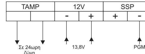
Σύνδεση με πέντε αγωγούς, με κέντρα PARADOX. Με τη χρησιμοποίηση του PGM.
